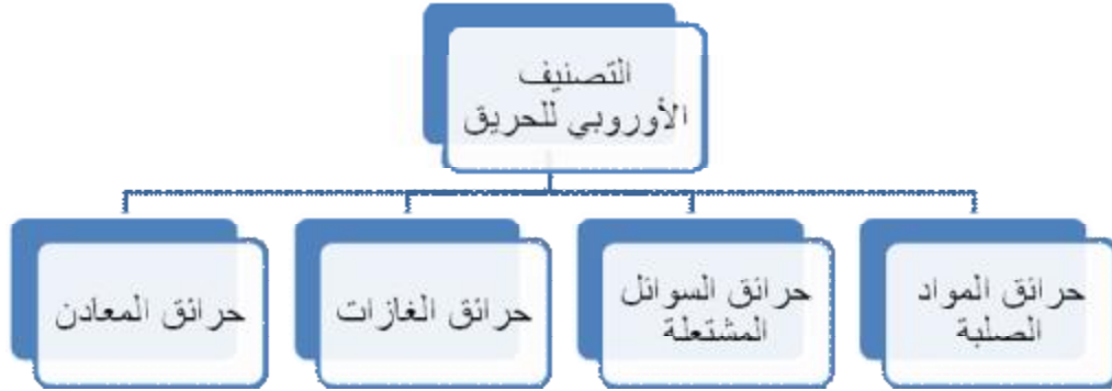
شكل رقم (2-3) يوضح التصنيف الأوروبي للحريق، (الباحث).
